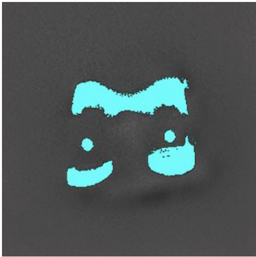
Abbildung 5: Volumenmessung im Gelphantom im MRT im Axialschnitt in der Standardsequenz: Es zeigt sich eine femorale Komponente der Keramiknie-TEP. Die Endoprothese ist nur von einem leichten Artefakt umgeben. Sie ist trotzdem klar vom Gelphantom abzugrenzen. In türkis markiert zeigt sich die durchgeführte Volumenmessung.
