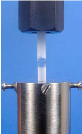
Abbildung 10: Anbringen der PMMA Stäbe
