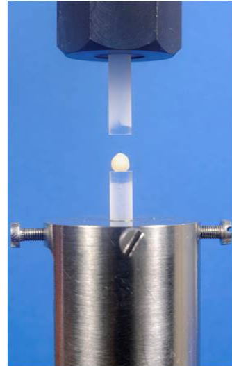
Abbildung 12: Einbringen der Kompositprobe
