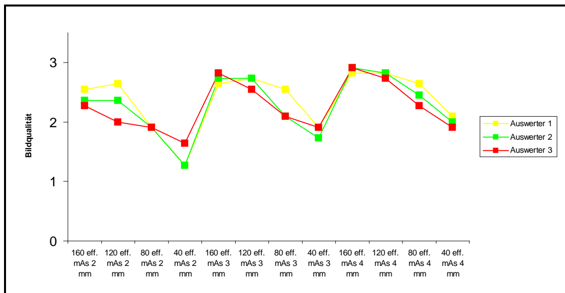
Abbildung 12: Einfluss des effektiven Röhrenstromzeitproduktes und der Schichtdicke auf die mittlere Bildqualität (1= ungenügend, 2= ausreichend, 3= gut) auf Höhe der Hüftkopfebene (alle drei Auswerter).
