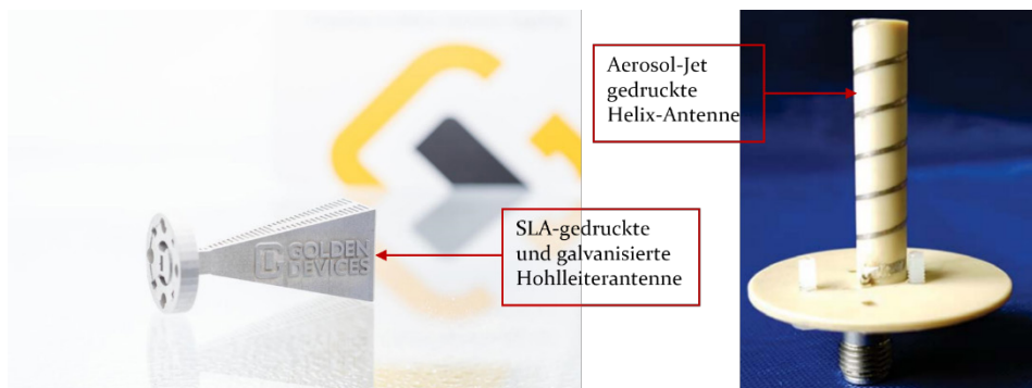
Bild 5: SLA-gedruckte Hohlleiterantenne, die im Anschluss galvanisch metallisiert wurde (Firma Golden Devices, links) und Helix-Antenne, die mit dem Aerosol-Jet Verfahren metallisiert wurde (Lehrstuhl für Hochfrequenztechnik, rechts)
