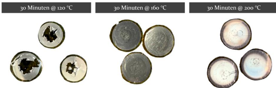
Bild 71: Aufnahme der Messproben nach dem Feuchte-Wärme-Test mit vollständig zerstörten Proben nach 120 °C Sinterung (links) und messtechnisch auswertbaren Proben nach einer Sinterung bei 160 °C (mittig) und 200 °C (rechts)
