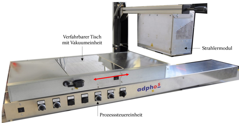
Bild 34: NIR-96-250-E System der Firma adphos Digital Printing mit der Prozesssteuereinheit, verfahrbarer Probestisch und Strahlermodul
