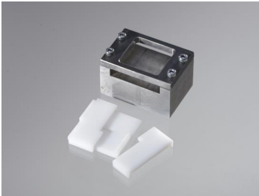
Abb. 8 Probenform für die Kompositkreuz-Herstellung in Einzelteilen
